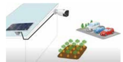
太陽光パネルとバッテリー、接続機器が独立しており、接続ケーブルも延長ができるのでカメラにも太陽光パネルにも最適な設置が可能です。
