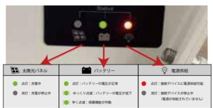
リチウムバッテリーの側面には管理用LEDインジケータを搭載しています。バッテリーの状態やソーラーパネルの充電状況や電源の供給状態を一目で確認できます。
